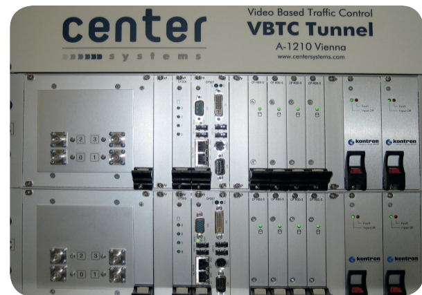
Bild 4: Der Systemaufbau der VBTC Tunnel VESA-Einheiten von links nach rechts: PCI basierte Framegrabber- Karten, RAID-Controller, Kontron CP-307 CPU-Board, vier Festplatteneinschübe sowie zwei Netzteile.
