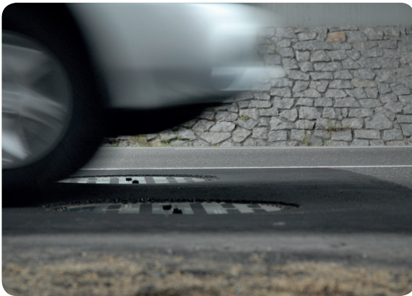
Bild 1: Beim Messverfahren ProContour H3-D mit ThinkIO-Duo werden Reifenprofiltiefen berührungslos bei bis zu 120 km/h fließendem Verkehr gemessen.
