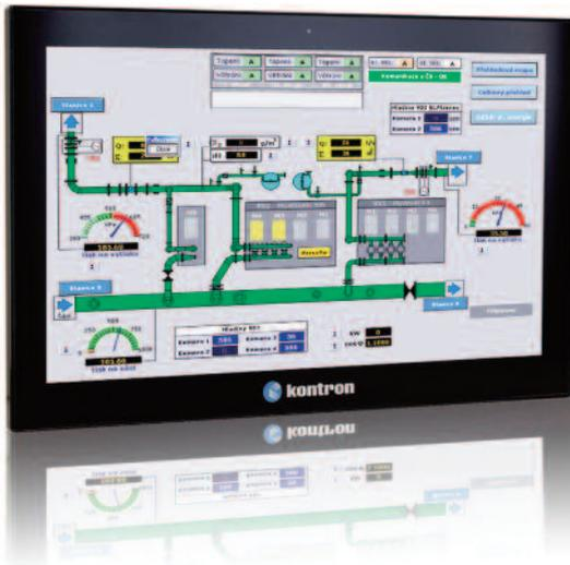
Um den Überblick bei der Steuerung auch komplexer Anlagen nicht zu verlieren, steht Fertigungsunternehmen eine neue Generation von Human Machine Interfaces zur Verfügung. Die Geräte orientieren sich zunehmend am 'Look and Feel' von Smartphones. Entsprechende Touchpanel-PCs gestatten Anwendern und Anbietern, neue Konzepte in Hinblick auf Bedienbarkeit und Design umzusetzen.
